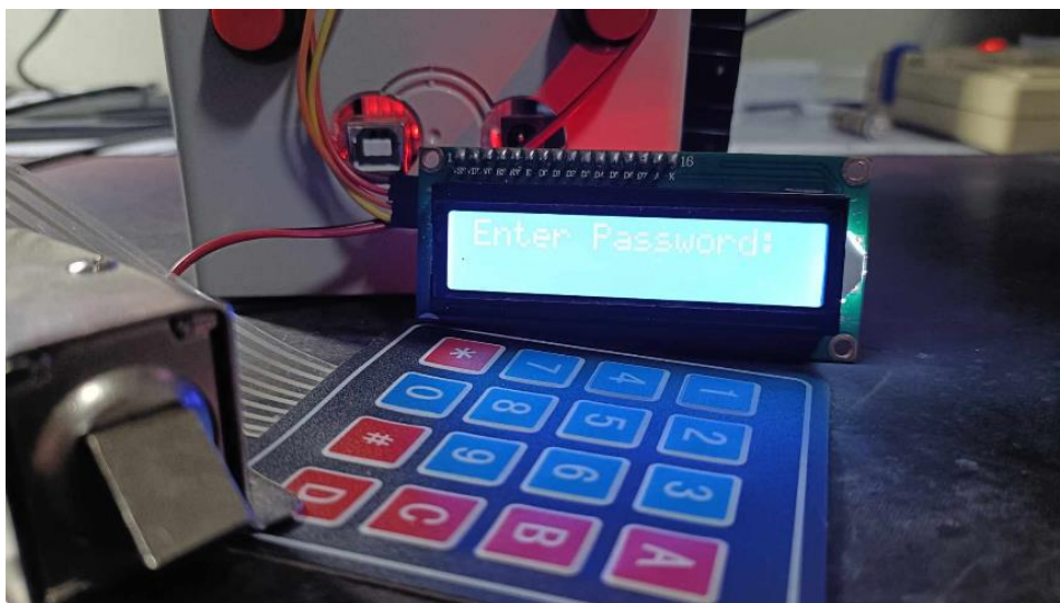
รูปที่ ก.10 ทดลองเปิดปิดโดยใช้ Keypad
