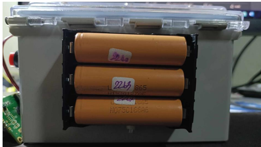
รูปที่ ข.11 วิธีการใส่แบตเตอรี่ลิเทียม
