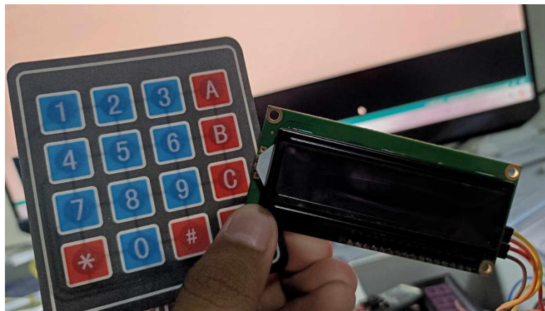
รูปที่ ก.6 เพิ่ม Keypad และจอ LCD
